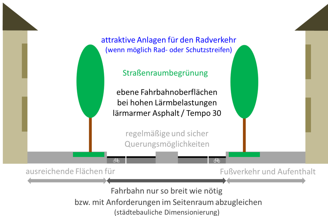
Abb. 27 idealtypischer Straßenquerschnitt im Sinne der Lärminderung
